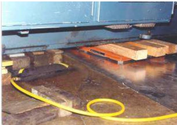
Aero-Jacks können zum Verschieben, Anheben oder als Vorbereitung für das Aufhängen einer Last eingesetzt werden.
