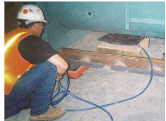
Da ein entlüfteter Aero-Jack sehr flach ist, lässt er sich leicht unter die meisten Lasten legen. Hier wird er verwendet, um die Hubhöhe zu vergrößern.
