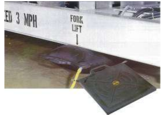
Die flachen Aero-Jacks lassen sich zum Anheben von Lasten rasch aufblasen.
