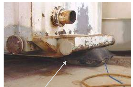
Der Aero-Jack wurde in eine 5 cm hohe Lücke unter der Last eingeführt und aufgeblasen, um 10 t auf eine Höhe von 7,5 cm anzuheben.
